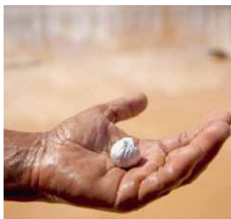
L'amalgame, boulette d'or et de mercure, qui est ensuite chauffé à 400 degrés.
