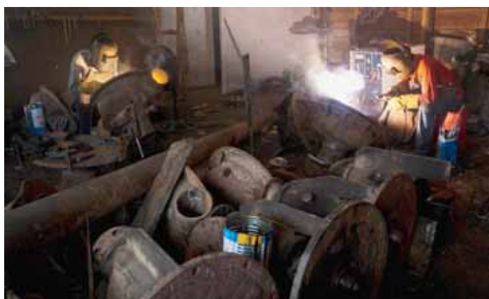
Les installations d'extraction, et notamment les motopompes, sont fabriquées avec des matériaux locaux, souvent de récupération.
