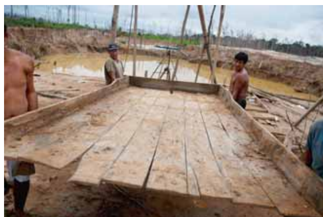
La rampe de lavage est déplacée toutes les trois semaines. Elle utilise beaucoup de bois. PHOTOS: RODRIGO ABD POUR KEYSTONE
